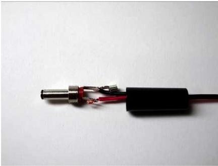
平行コードの両端をそれぞれ約1cm裂き、ビニールの被覆を5mmほど除去します。コードをDCプラグのキャップに通して電極の穴に差し込みます。赤と黒はどちらでも構いません。
