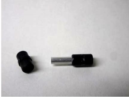
アルミパイプ17.5mmの端から約3分の1の辺りをペンチで少し押しつぶしておき、シャフトを通したときに抜けないようにします。2.9Wブッシュの突起を削ってアルミパイプのつぶした側を打ち込みます。アルミパイプの余った部分には3.1Wブッシュをそのままかぶせます。同じものを2セット作ります。
