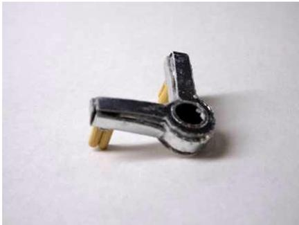
Q1に木工ボンドをつけ、J13に納めます。そしてQ2でふたをします。ボンドが生乾きのうちに形を整えてください。
