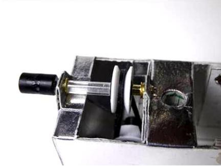
プラ丸棒をプーリーに通し、シリコンゴムベルトを引っかけてから、隙間にハトメを入れて端まで突き通します。写真のようなゴムベルトのひねり方は右ねじドリルの場合で、前進しながらドリルが右に回ります。左ねじドリルにする時は、反対にひねってください。
