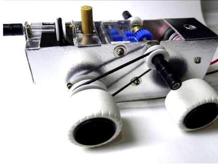
ギヤボックスが透明なので取り付けネジの位置が確認できます。シリコンバンドを動力シャフトと前輪のプリーにかけてください。
