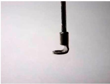
丸形圧着端子の丸穴の付け根をペンチで90°曲げます。
