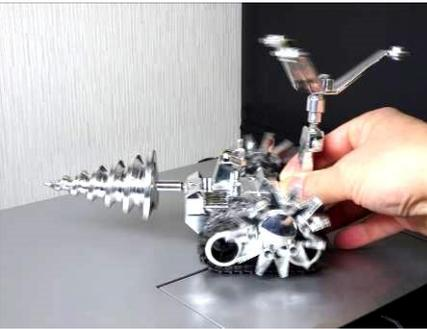
メカユニットから本体をはずし、いもネジを六角レンチで緩めてクラッチを切ると、手転がしで走行できるようになります。手で押せば、ドリル、スピングヤ、履帯、アームが回ります。いもネジを締めてクラッチをつなぐとリモコンでモーター走行します。
