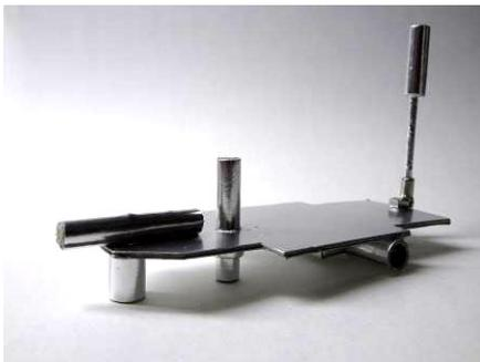
25mmの竹ひごに木工ボンドをつけながらI11を巻きつけて丸棒を作ってください。シャーシーの穴にさして、ボディの連結に使います。
