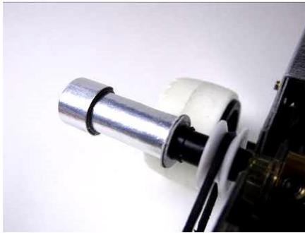
左右に突き出したシャフトの両端に、円筒の太い方を外側にして差し込んでください。削ってないブッシュの突起に当たる位置で止めます。
