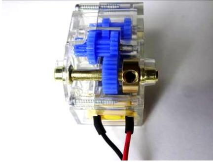
真鍮パイプをハトメに差し込み、ファイナルギヤとストッパーに通します。ストッパーの穴と真鍮パイプの穴が重なるように位置を合わせてください。
