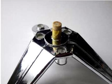
丸棒を長さ14mmに整え、9mm分をマスキングテープで覆います。中央の穴に5mmだけ差し込んで木工ボンドで接着してください。
