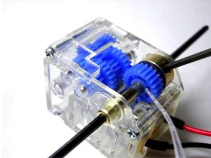
72mmブラック強化シャフトを真鍮パイプに通し、ストッパーにイモネジを差し込んでレンチで締めます。イモネジを緩めると真鍮パイプ内でシャフトが自由に動き、締めると動かないことを確かめてください。確認できたらファイナルギヤと真鍮パイプを接着してください。
