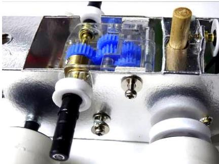
モーターのコードを半分の長さに切り、先端の被覆を約5mm除去してください。ギヤボックスをメカユニットに取り付け、2mmなべ小ねじで固定してください。
