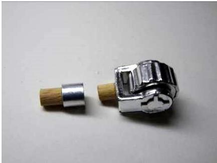
Q8をプラパイプに巻き付けて円筒を作り、長さ7mmの丸棒を深さ1mmだけ差し込んで木工ボンドで接着します。十分に乾いた後、11に接続します。
