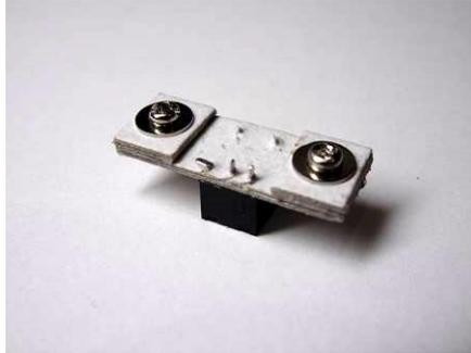
六角形の穴に2mm小ネジのナットを埋め込んでおきます。DCジャックに接着剤をつけて写真のように3本の足を基板に差し込みます。1本だけ使わない足があるので、倒しておいてください。
