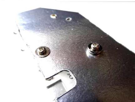
11の部品をメカユニット内側に当て、外側からワッシャーを挟んだ2mm小ねじをナットに通して取り付けます。右下の小ねじにはさらにスプリングワッシャーと平ワッシャーを追加し、ネジの実質的な長さを縮めます。
