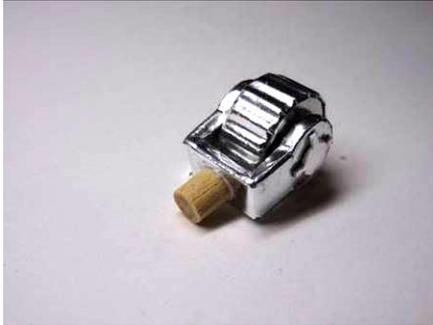
5mm丸棒を長さ5.5mmにカットして車輪受けに木工ボンドで接着し、十分に乾かします。
