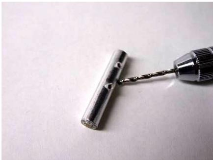
I10を丸める前にネジ止め位置に画鋸で穴を空けておいてください。長さ27mmの竹ひごを芯にして、木工ボンドをつけたI10を巻き付けます。画鋸の穴が外側になるように巻き付けてください。ボンドが完全に固まってから、ネジ止め位置に1.5mmのドリルで下穴を空けてください。
