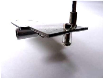
φ5mmプラパイプを長さ6mmに切り、2.6mmなベ小ねじを通してシャーシー後端の穴に下から差し込みます。穴の上には、前述の鉛直シャフトの圧着端子を挟んでナットを締めてください。
