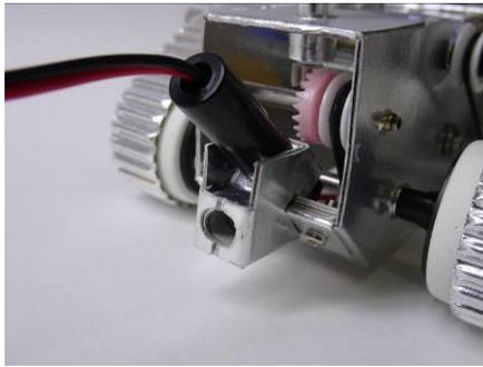
メカユニットの後端に転倒防止装置を写真のように挟みます。斜めの穴には電源リモコンのプラグを差し込んでください。
