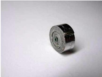
3mmプラパイプを長さ7.5mmに切り、木工ボンドをつけながらQ4とQ5をプラパイプに巻き付けます。
