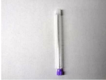
アクリル棒を長さ58mmに、3mmプラパイプと5mmプラパイプをどちらも長さ48mmに切り、重ねてアクリル棒を差し込み、白と紫のピンオンをはめ込みます。
