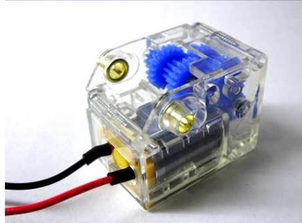
田宮ミニモーター低速ギヤボックス（4速）を製品の説明書通りに④まで組み立ててください。ギヤ比の選択は71.4:1としてください。
