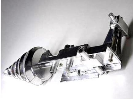
連結棒を操縦装置の下に差し込み、鉛直シャフトをシート背もたれに差し込んで本体とシャーシーを連結します。
