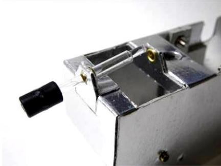
プラ丸棒を1.9Wブッシュに差し込みます。これをメカボックス前方から差し込む時にプラパイプに通します。
