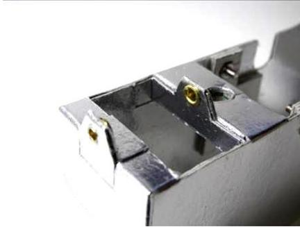
2mmプラ丸棒は長さ32mmに切っておきます。1.9Sのブッシュを11mmプーリーにはめておきます。1.9Wのブッシュの突起を削り落とします。3mmプラパイプは長さ10mmに切っておきます。ハトメは3個使いますが、2個をメカユニット上部に内側からはめ込んでください。
