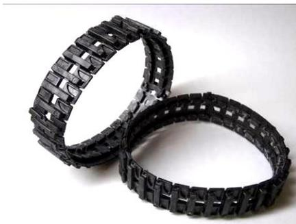
また、TAMIYAの「トラック&ホイールセット」の履帯をメカユニットに取り付けると、走行性能が格段に向上します。黒とメタリックグレイの2種類が市販されています。30コマだけ用い、裏面をサンドペーパーで少し削ってサイズを調整する必要があります。
